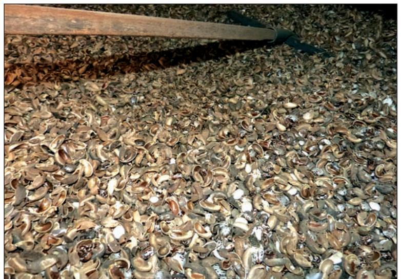
Ein Blick in die Produktionshalle: Beim Schälen der reifen Rizinusfrüchte fallen Schalenreste in Mengen an. Ab sofort werden auch sie genutzt und zu Briketts gepresst. Sie können dann zum Heizen verwendet werden.
